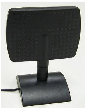
パッチアンテナは、ユニットの上に置いたり（磁石付）、平らな場所に置いて使います。このとき、指向性面の方向へ電波を強く送信、または指向性面の方向からの電波を強く受信します（垂直偏波、水平面指向性）。指向性があるため、妨害に強くなりますが、アンテナの方向を合わせる必要があり、子機が複数ある場合や、移動する場合には適さない場合があります。親機とユニット U、またはユニット D と子機間の距離が数メートルを超える場合、また周囲に妨害源が多い場合に最適です。
