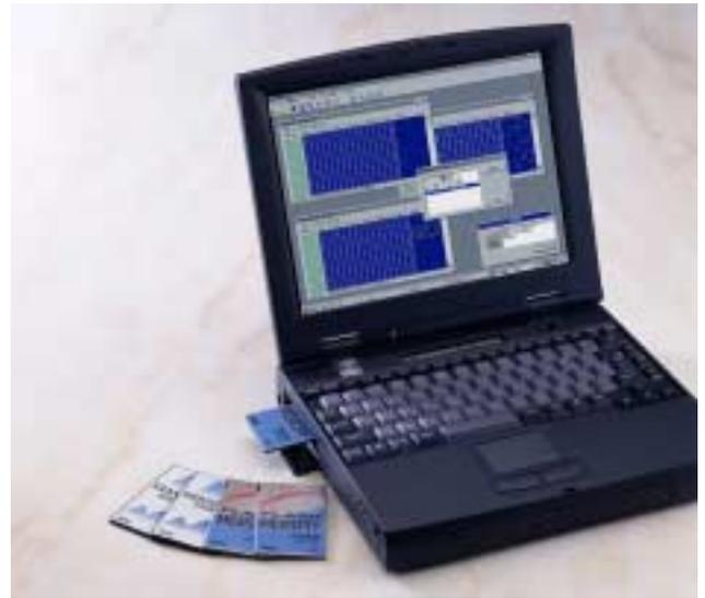
対応カード CardUTは国内十数社のPCカードに対応しており、SRAMカード、FLASHメモリカード、EEPROMカード、ATAカードに対してデータの読み書きやエディットを行うことができます。そして、これらのデバイスの混載カードに対応しています。
