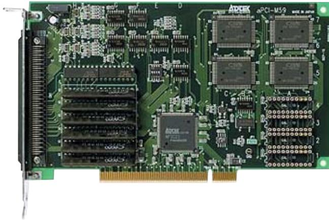
本ボードは、PCIバス拡張スロットを持っているPC98-NXシリーズおよび、PC/AT( DOS/V機 )またはその互換機に4軸ステップ/サーボモータコントローラの制御機能を付加する拡張ボードです。
